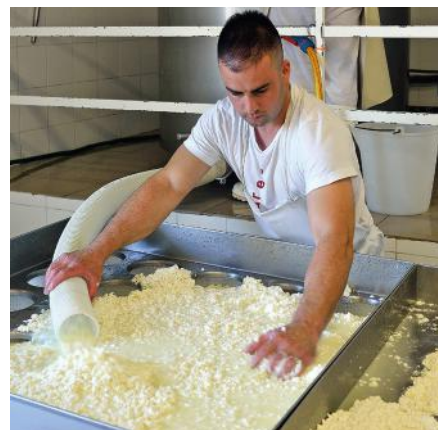
▲ À LA FROMAGERIE DEDONI, le lait caillé descend par gravité dans le répartiteur à moule.
